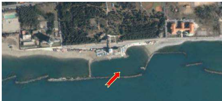
Figura 1 – tratto di litorale massese in cui si è verificata la fioritura di alghe tossiche: sono evidenti i pennelli perpendicolari alla riva e le scogliere soffolte parallele ad essa, la freccia indica la zona di massima concentrazione delle alghe
